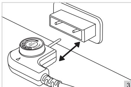
4. Ajustez le cadran du thermostat à la température requise (voir Figure 4) :
