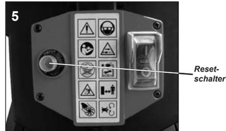
Mindestens 1 Minute bis zum Neustart zuerst durch Drücken des Reset-Schalters und dann des Ein-/ Aus-Schalters warten. Sollte der Motor nicht wieder anspringen, Folgendes unternehmen:
