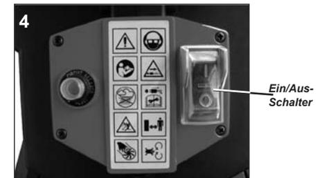
Mit einem Druck auf den Ein-/Aus-Schalter kann die Maschine gestartet bzw. gestoppt werden.
