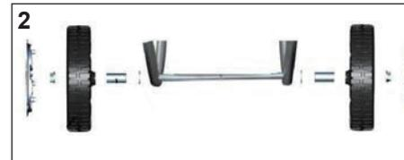
Die mitgelieferten Distanzhülsen auf die Radachsen setzen. Anschließend die Räder und schließlich die Sicherungsmutter mit der Radkappe anbringen.
