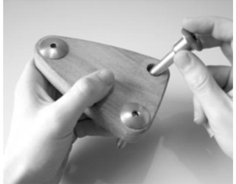
Nehmen Sie jetzt eine der dreieckigen Holzwanzen. Eine Seite der Holzwanze ist mit einem farbigen Aufkleber markiert, dies ist die Innenseite der jeweiligen Holzwanze. Halten Sie mit einer Hand die Holzwanze so, dass die mit dem Aufkleber markierte Seite nach unten weist. Mit der anderen Hand stecken Sie durch jedes der drei Bohrlöcher eine Gewindestange mit Rundmutter.
