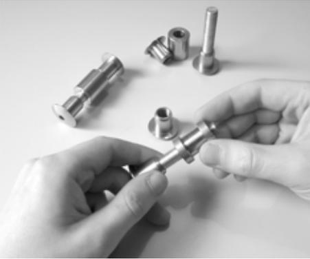
Einige Metallteile sind zur Prüfung der Gewinde vormontiert. Für den Zusammenbau müssen Sie diese zunächst einmal zerlegen. Nehmen Sie die drei vormontierten Gewindestangen, schrauben Sie jeweils eine der Rundmuttern ab und nehmen Sie die jeweilige Edelstahl-Buchse von der Gewindestange herunter. Die auf der Gewindestange verbliebene Rundmutter schrauben Sie handfest an. Sie haben nun drei Gewindestangen, an die jeweils eine Rundmutter angeschraubt ist.
