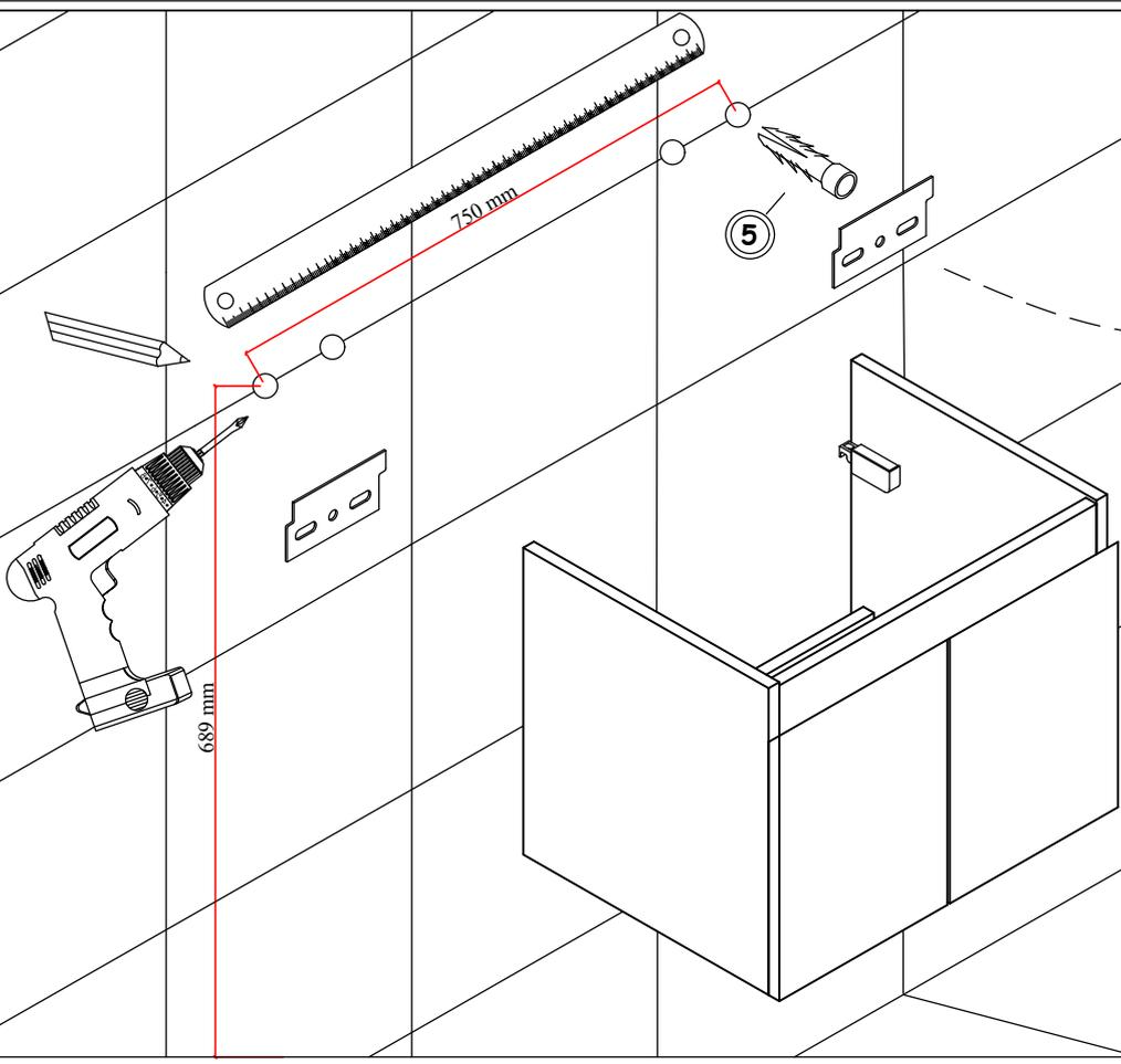
BOHREN SIE MIT EINEM SCHLAGBOHRER LÖCHER ENTSPRECHEND DER ANGEZEIGTEN ABSTÄNDE ZUR ANBRINGUNG DER AUFHÄNGUNGSELEMENTE. STECKEN SIE ANSCHLIESSEND DIE DÜBEL IN DIE LÖCHER. VERSCHRAUBEN SIE DIE AUFHÄNGUNGSELEMENTE IN DIE ANGEBRACHTEN DÜBEL.
