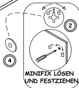
PLATZIEREN SIE DIE MINIFIX STECKER UND VERBINDERGEHÄUSE UND SCHRAUBEN SIE DIESE FEST.
