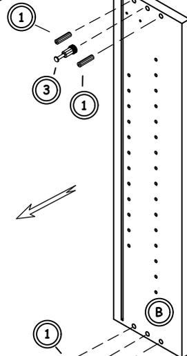
MONTAGE DER MINIFIX-VERBINDUNGSBOLZEN IM LOCH
