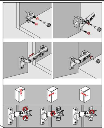
POSITIONIEREN SIE DIE BEREITS VERDÜBELTEN SCHARNIERE IN DIE OBEREN UND UNTEREN LÖCHER UND BEFESTIGEN SIE DIESE DURCH DIE ZWEI LÖCHER AM SCHRANK.
