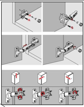
POSITIONIEREN SIE DIE BEREITS VERDÜBELTEN SCHARNIERE IN DIE OBEREN UND UNTEREN LÖCHER UND BEFESTIGEN SIE DIESE DURCH DIE ZWEI LÖCHER AM SCHRANK.
