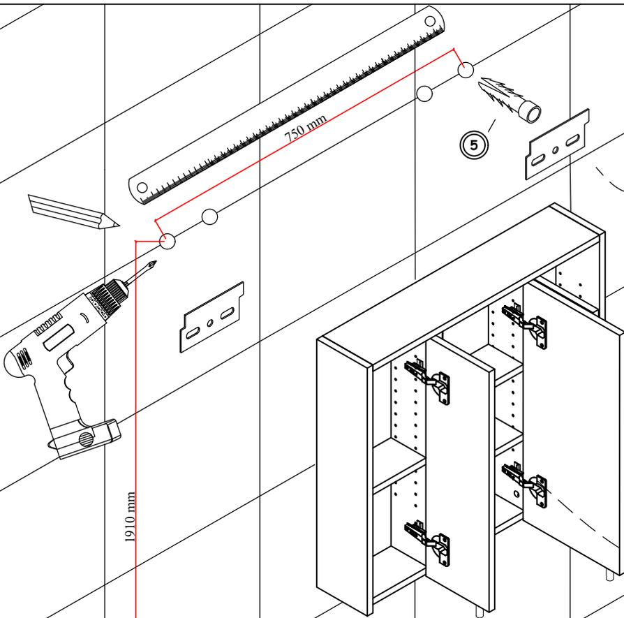
BOHREN SIE MIT EINEM SCHLAGBOHRER LÖCHER
