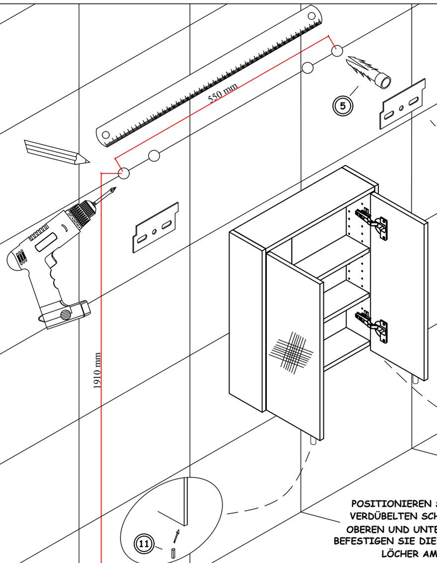
BOHREN SIE MIT EINEM SCHLAGBOHRER LÖCHER
