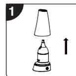
Schalten Sie das Gerät AUS und ziehen Sie es von Steckdoses ab. Heben Sie dann die obere und die innere Abdeckung ab.
