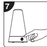
Mit der Modus-Taste schalten Sie das Gerät ein und wählen die gewünschte Funktion aus.
