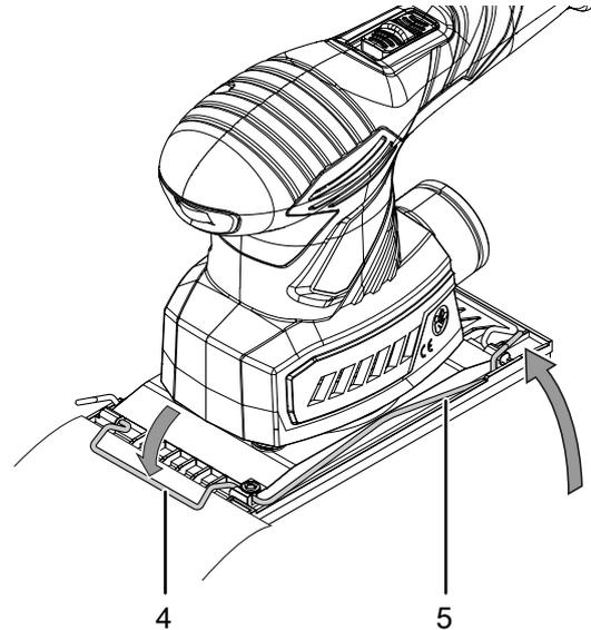
4. Führen Sie das Schleifblatt straff unter der Schwingschleifplatte zur anderen Klemmleiste.
