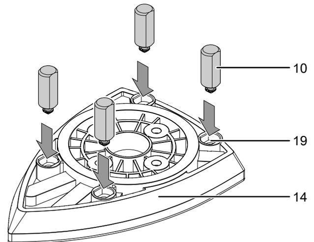
6. Legen Sie die Schwingschleifplatte (6) oder Dreieckschleifplatte (14) auf den Flansch (16). Bei der Schwingschleifplatte (6) muss die Pfeilmarkierung (20) nach vorn zeigen. Bei der Dreieckschleifplatte (14) muss die Spitze nach vorn zeigen.
