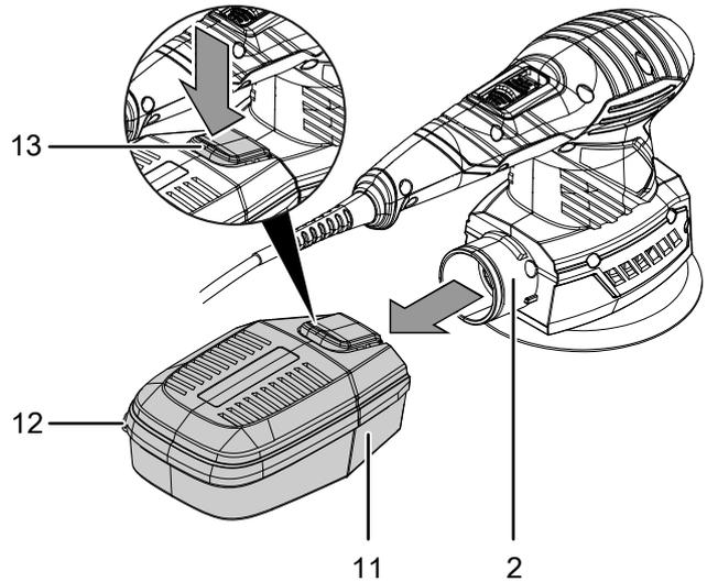
2. Öffnen Sie die Staubbox, indem Sie an der Lasche (12) ziehen.
