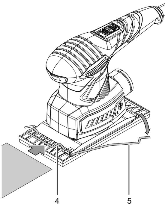
2. Schieben Sie das Schleifblatt mit der glatten Unterseite unter die offene Klemmleiste.
