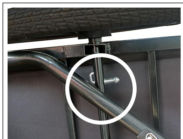
STECKEN SIE DEN SICHERUNGSSTIFT DURCH DAS LOCH IN DER ACHSE UND ZIEHEN SIE IHN FEST.
