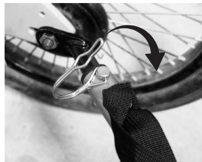
INSÉREZ LE BOULON DU CLIP À RESSORT DANS LES TROUS DES DEUX PIÈCES D'ACCOUPLEMENT ET FERMEZ LE SUPPORT DE SORTE QUE L'OUVERTURE DU CLIP ENTOURE L'EXTRÉMITÉ DU BOULON.
