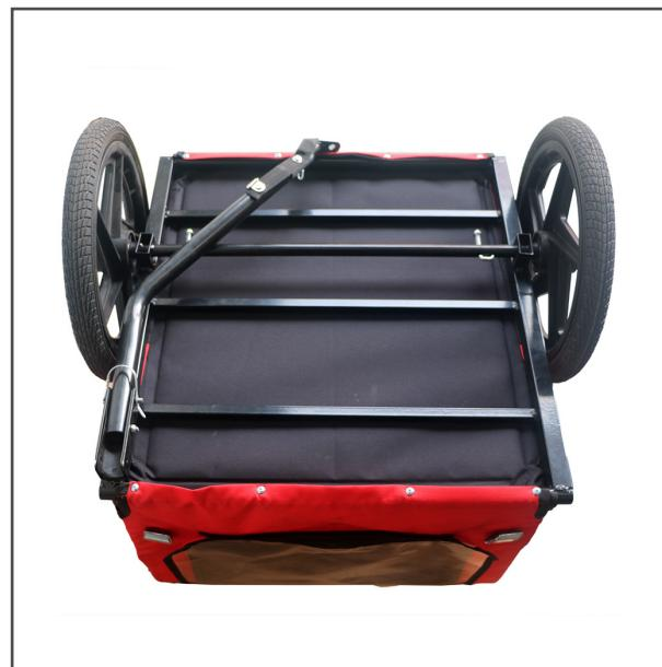
UNTER DAS FAHRZEUG GEKLAPPT ZUR ERREICHUNG KLEINER ABMESSUNGEN BEIM VERSTAUEN.
