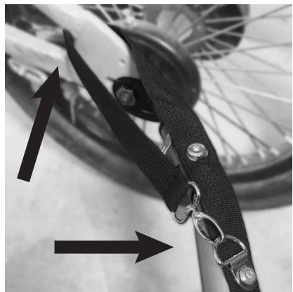
ACHTUNG: IMMER DAS SICHERUNGSBAND AN DER KETTENSTREBE BEFESTIGEN!
