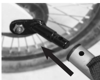
SCHIEBEN SIE DEN RUNDEN DEICHSELANSCHLUSS BIS ZUM ANSCHLAG ÜBER DAS ANS FAHRRAD MONTIERTE KUPPLUNGSSTÜCK.
