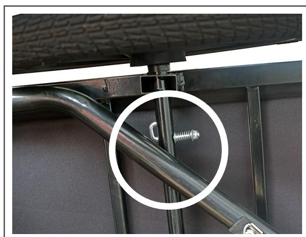
INSÉREZ LA GOUPILLE DE SÉCURITÉ DANS LE TROU DE L'AXE ET SERREZ-LA.
