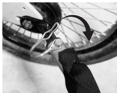
STECKEN SIE DEN FEDERCLIP-BOLZEN DURCH DIE BOHRUNGEN DER BEIDEN KUPPLUNGSTEILE UND SCHLIESSEN SIE DEN BüGEL, SO DASS DIE ÖFFNUNG DES CLIPS DAS BOLZENENDE UMFAST.
