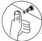
MONTAGE DER MINIFIX-VERBINDUNGSBOLZEN IM LOCH
