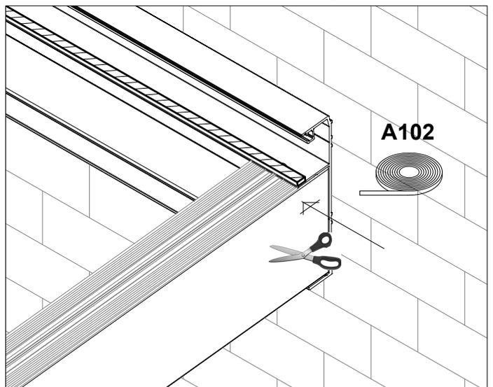
Kleben Sie das Fugenband auf die Enden des Profils der Rinnen- und der Wandpfette auf und schneiden es dann seitlich bündig mit den Sparren ab.
