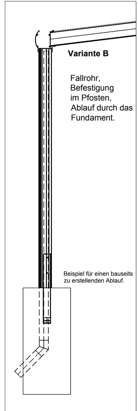
Fallrohr mit Schraubstutzen, Laubfangkorb und Rohrbogen zusammenstecken, ausrichten und verkleben.
