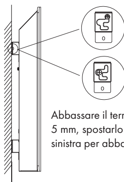
Rimuovere il termoconvettore dalla parete
