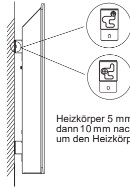
Den Heizkörper von der Wand nehmen
