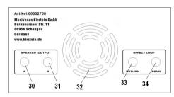
An der Effektloop (Buchsen Send/Return) können Sie zusätzliche externe Effektgeräte wie Hall, Tremolo, etc. einschleifen. Achten Sie darauf dass der Lüfter gut zugänglich ist und das Gerät nicht zu nahe an einer Wand aufgestellt ist. Überprüfen Sie den Lüfter gelegentlich auf Verschmutzung durch Staub.
