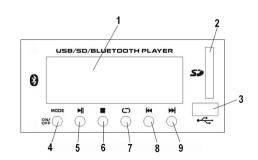
Der Player spielt Audiofiles der folgenden Formate: MP3 und WAV. Stecken Sie eine SD-Card oder einen USB-Stick in einen der Slots/Ports (2) oder (3). Mit der Taste MODE
