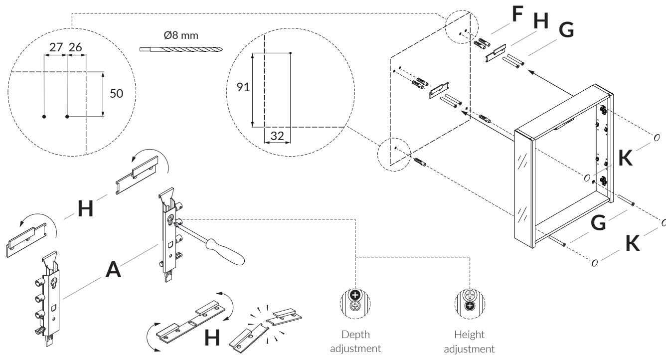
**D.** Das beigegebügerte Wandbefestigungsmaterial (Dübel und Schrauben) eignet sich nur für festes Mauerwerk (z. B. Beton- oder Ziegelwände). Für andere Wandaufbauten sind eventuell Spezialdübel und andere Schrauben notwendig. Ziehen Sie gegebenenfalls eine Fachkraft zurate.
