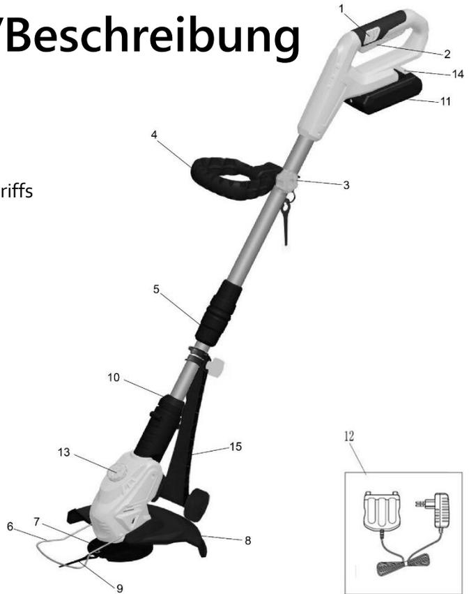
**Montage der Schutzhaube** Schieben Sie die Schutzhaube in Pfeilrichtung auf das Motorgehäuse. Stellen Sie sicher, dass sie korrekt einrastet!
