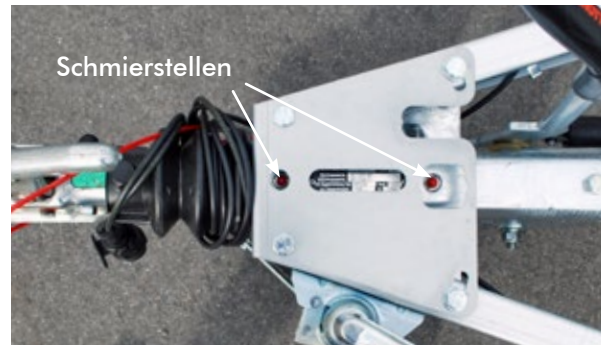
Schmierstellen der Auflaufeinrichtung
