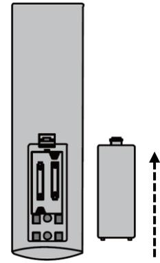
**TV-Fernbedienung:** Schließen Sie das Batteriefach auf der Rückseite der Fernbedienung, indem Sie die Abdeckung in Pfeilrichtung auf die Fernbedienung schieben.
