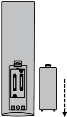
**TV-Fernbedienung:** Öffnen Sie das Batteriefach auf der Rückseite der Fernbedienung, indem Sie die Abdeckung in Pfeilrichtung von der Fernbedienung herunterschieben.
