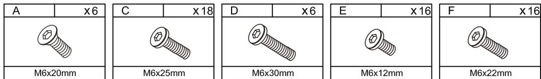
Bitte beachten Sie, dass die Formen der Schrauben A und C und D und E und F ähnlich sind. Bitte installieren Sie entsprechend der Anleitung und unterscheiden Sie sie!
