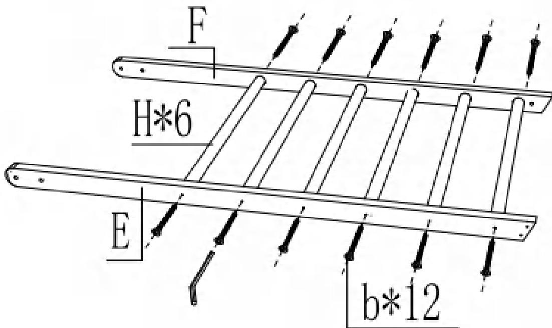
Connectez E et F avec 6 pièces de H et connectez-les avec 12 pièces de M6\*30.
