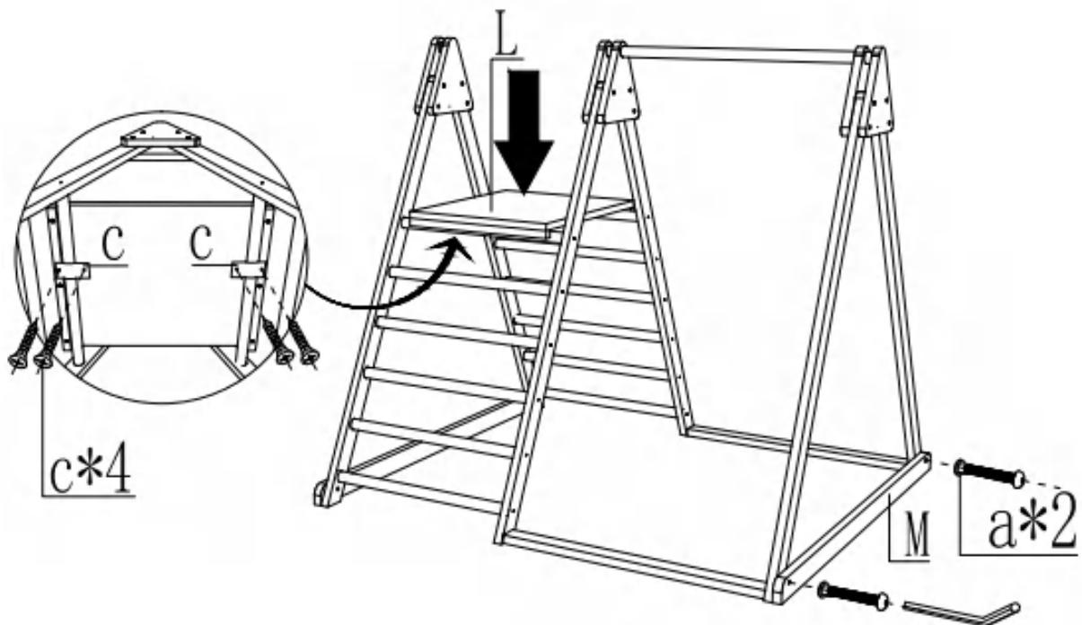
Installez la planche L sur l'échelle d'escalade et ajoutez le support inférieur M au bas du trépied comme indiqué sur la figure, et connectez-les avec deux pièces de M6 \* 30.
