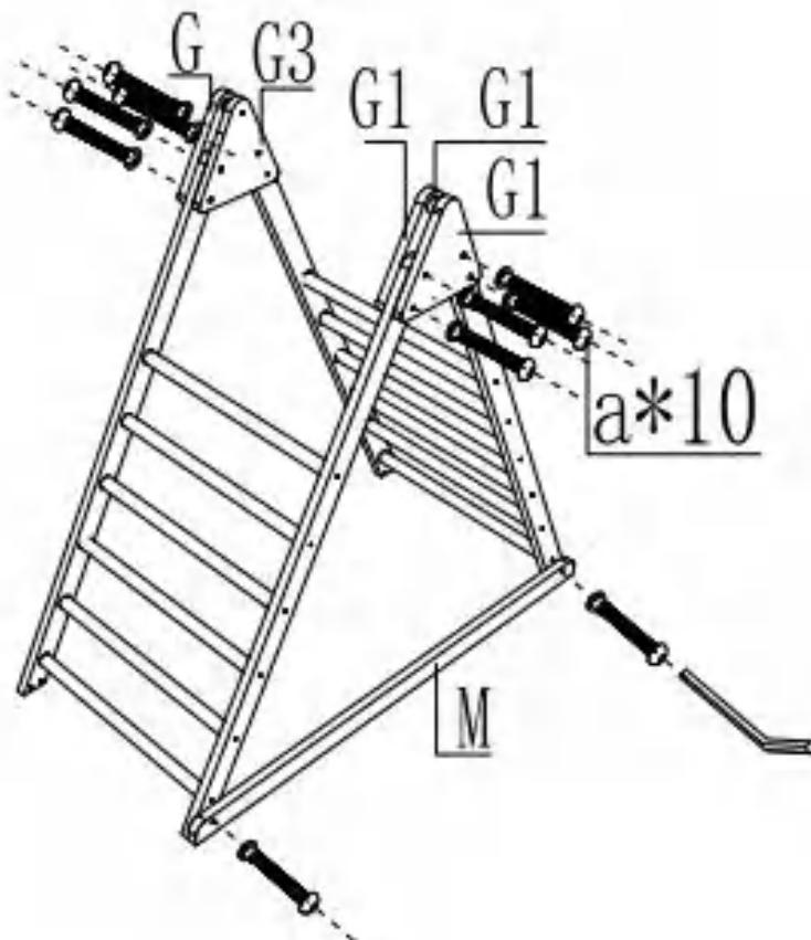
Verbinden Sie die im ersten und zweiten Schritt verbauten Teile mit G, G1, G3, und legen Sie den passenden Zierklotz mit G1 zwischen die beiden G1 Dreiecksplatten und befestigen Sie sie mit 10 Stück M5\*60. Befestigen Sie dann das Tretlager M mit 2 Stück M5\*60 an der Unterseite des Dreiecks. Legen Sie es dann für eine spätere Verwendung beiseite.
