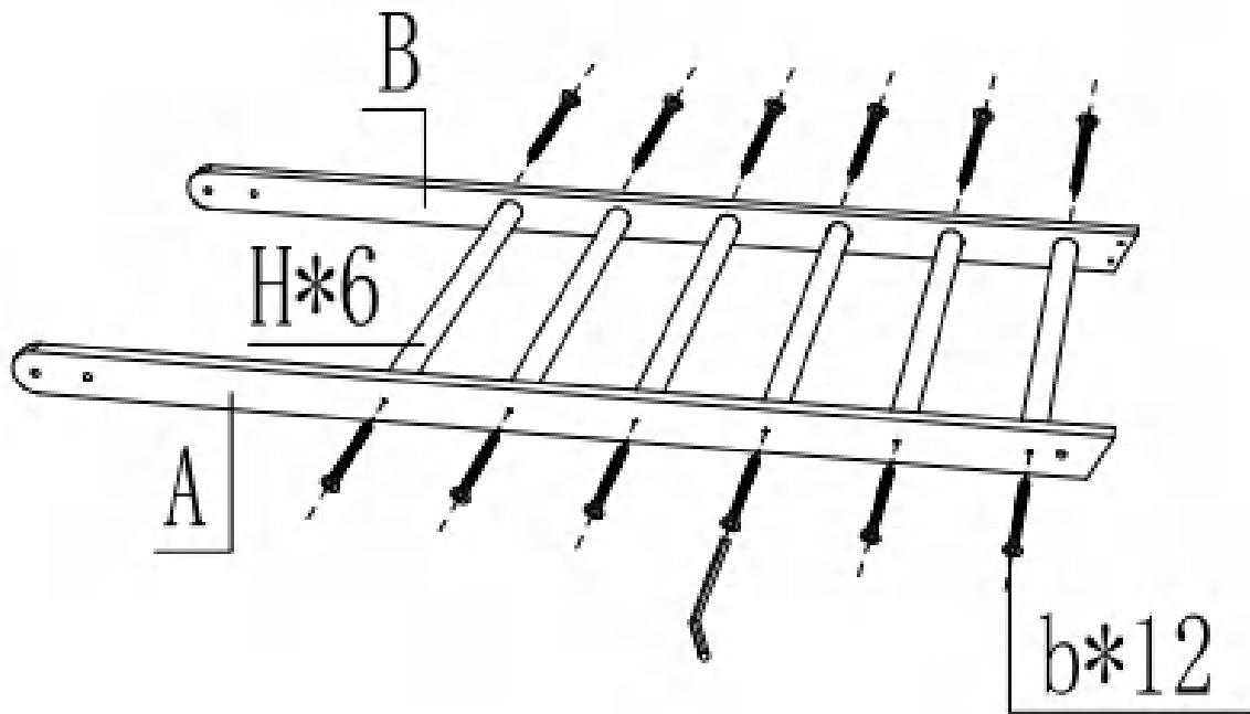
Connectez A et B avec 6 pièces de H et connectez-les avec 12 pièces de M6\*30.
