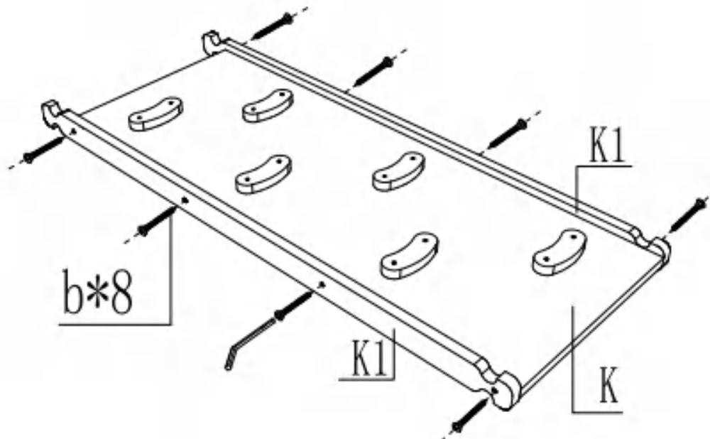
Verbinden Sie zwei Schieberseitenteile K1 mit Schieber K mit 8 Stück M6\*30.
