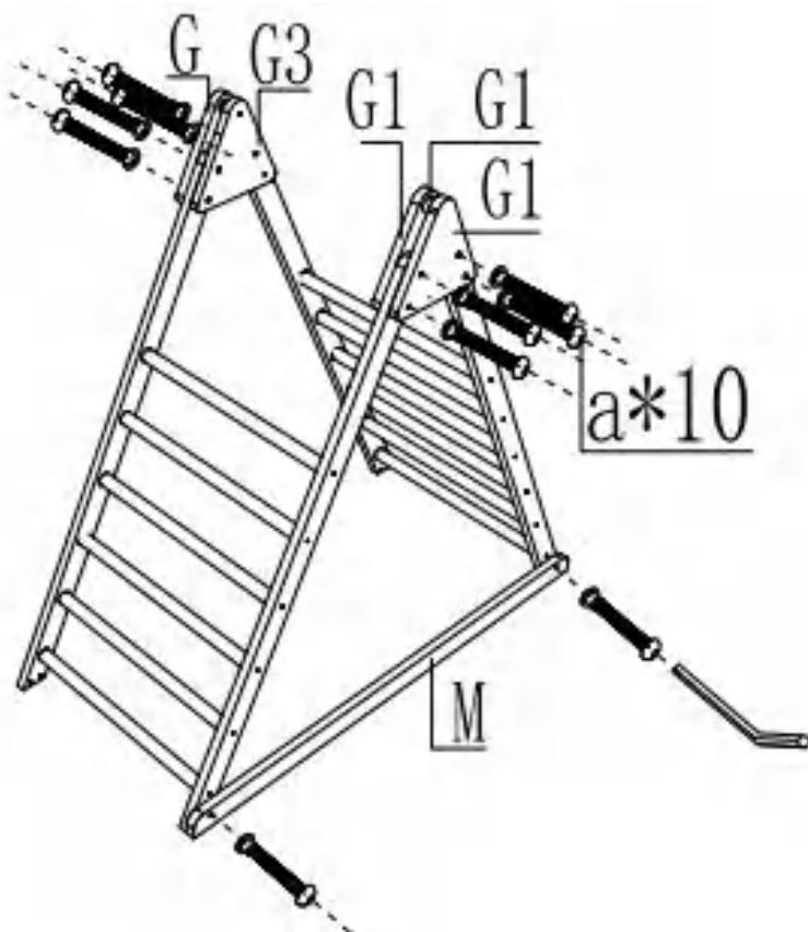
Connectez les pièces installées dans les première et deuxième étapes avec G, G1, G3, et placez le bloc décoratif assorti avec G1 entre les deux plaques triangulaires G1 et fixez-les avec 10 pièces de M5\*60. Ensuite, fixez le boîtier de pédalier M avec 2 pièces de M5\*60 au bas du triangle. Ensuite, mettez-le de côté pour une utilisation ultérieure.
