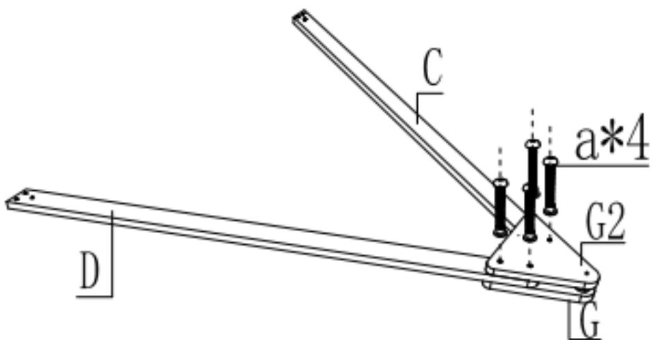
Connectez C et D à G et G2 et fixez-les avec 4 pièces de M5\*60. Ensuite, mettez-le de côté pour une utilisation ultérieure.
