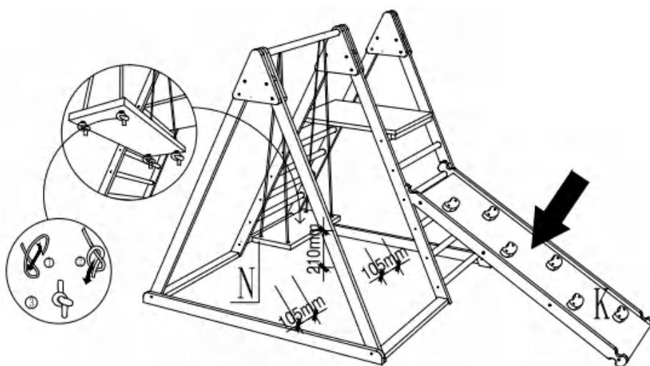
Installieren Sie die Schaukel in der entsprechenden Position. und legen Sie den Schieber auf den ersten oder zweiten runden Stab des Hauptkörpers, und der gesamte Installationsvorgang ist abgeschlossen (bitte platzieren Sie ihn nicht auf dem dritten oder oberen runden Stab, da dies sonst aufgrund des übermäßigen Neigungswinkels zu Gefahren führt).
