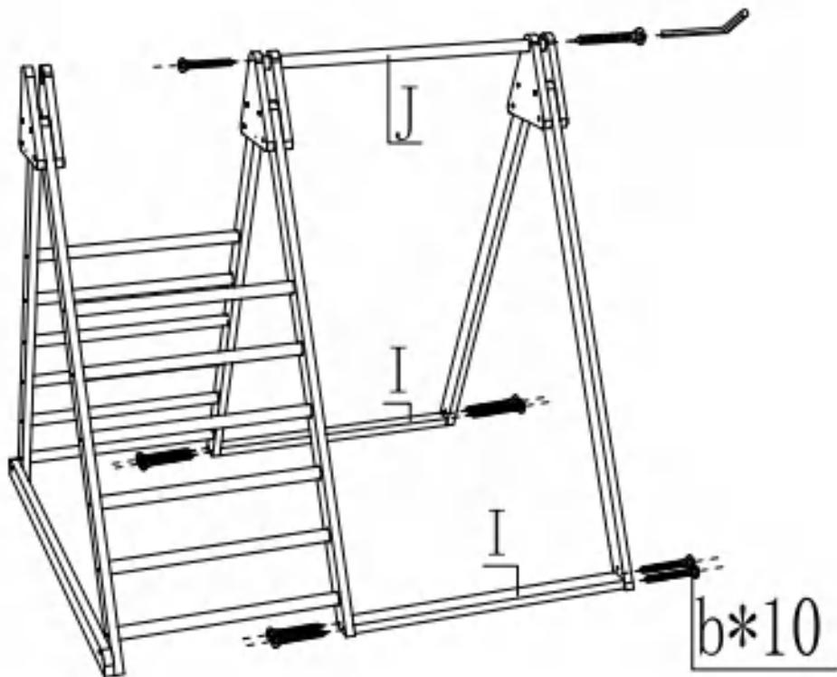
Connectez les pièces installées dans les étapes 3 et 4 avec 10 pièces de M6 \* 30.
