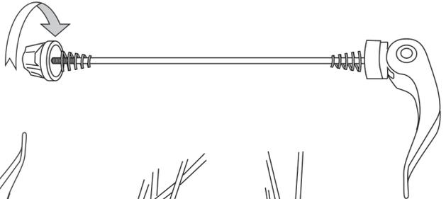
**i** Sie müssen die Stellmutter und eine Feder von dem Spieß entfernen, indem Sie sie gegen den Uhrzeigersinn drehen.
