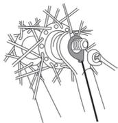
Die Sicherungsscheibe muss über den Bolzen geschoben werden.
