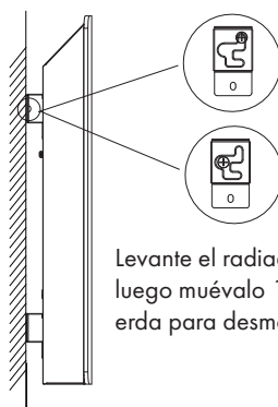
Desmontar el calefactor de la pared
