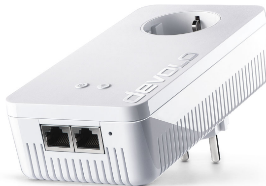
Abb. 2: dLAN 1200+ WiFi ac mit landesspez. Stecker/Steckdose
