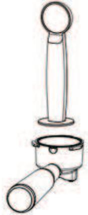
Befestigen Sie den Siebträger im Brühkopf. Schieben Sie den Griff nach links und drehen Sie ihn dann nach rechts, bis er einrastet. Lassen Sie den Griff los. Der Siebträger muss fest im Brühkopf sitzen und im 90°-Winkel nach vorne zeigen.
