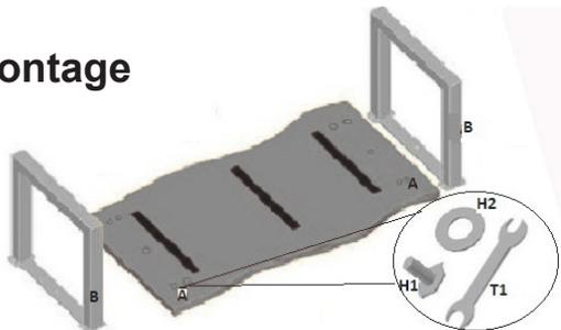
Mittels der Unterlegscheiben und den Schrauben montieren Sie die Füße an die Tischplatte.
