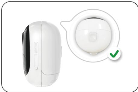
Pour retirer la batterie de l'appareil, tirez sur le bouton situé sur le dessus de la batterie et faites-la glisser vers le haut.
