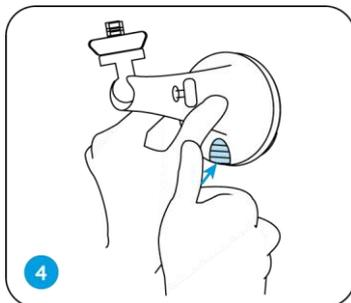
Appuyez sur le bouton du support de sécurité jusqu'à ce que sa plaque s'enclenche dans le support.
