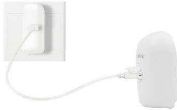
Méthode 2 : Connectez directement la caméra avec l'adaptateur USB via un câble USB et branchez-la dans une prise électrique pour la charger.
