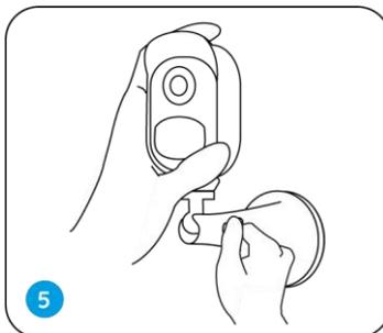
Vissez la caméra, ajustez le support et serrez le bouton pour le verrouiller.
