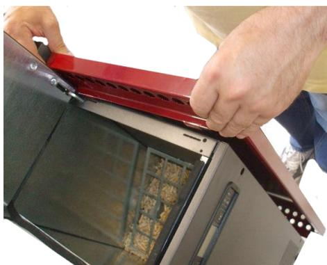
Fig. 29 - Einfügen der Platten
