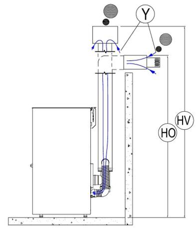
Fig. 12 - Anschlüsse Rauchabzugsrohr
