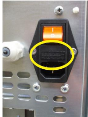
**Fig. 82 - Abdeckklappe mit Sicherungen, die ausgewechselt werden müssen**
