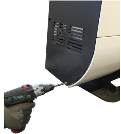
Fig. 33 - Untere Befestigung Platten
