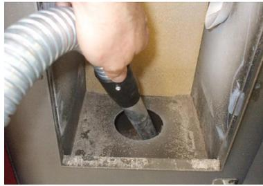
Fig. 71 - Reinigung Fach Brennschale
