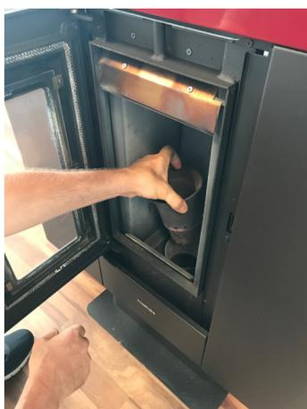
Fig. 68 - Brennschale entnehmen
