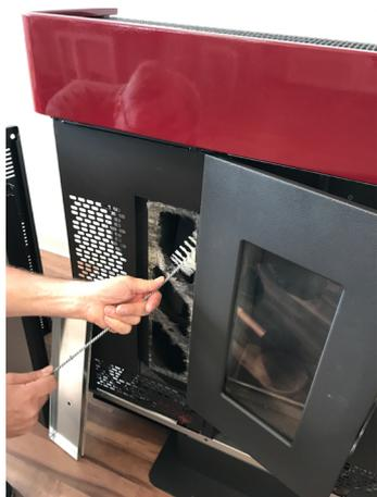
**Fig. 76 - Reinigung mit Flaschenbürste**
