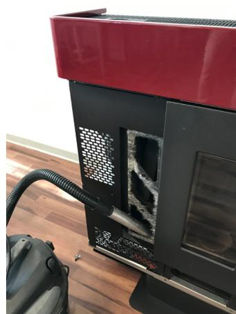
**Fig. 77 - Reinigung Rauchgaskammer**
