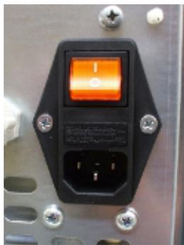
Fig. 41 - Elektrische Steckdose mit Hauptschalter
