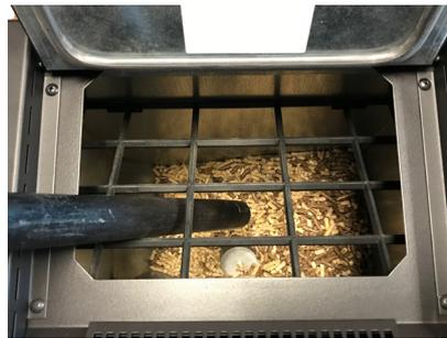
Fig. 73 - Reinigung Tank und Schnecke
