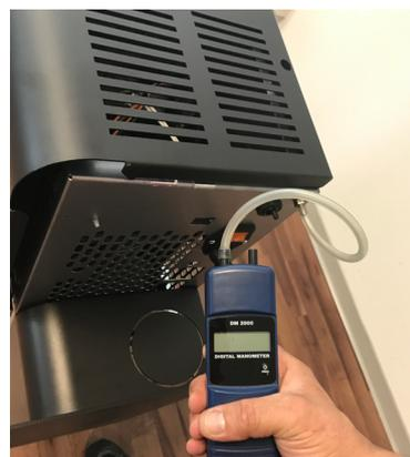
Fig. 47 - Anschluss des Digitaldruckwächters
