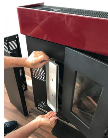
Fig. 75 - Die Inspektionsplatte entfernen
