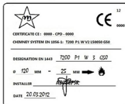
Fig. 3 - Beispiel für Typenschild
