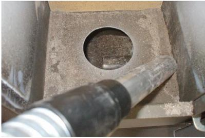
Fig. 70 - Reinigung Fach Aschenkasten
