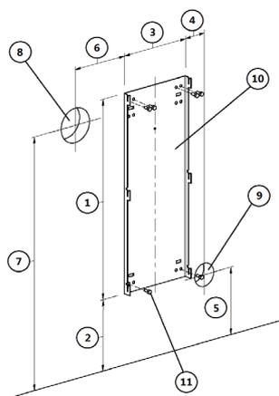
**Fig. 24 - Befestigung an einer nicht brennbaren Wand**
