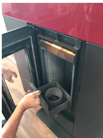
Fig. 69 - Reinigung Brennschale
