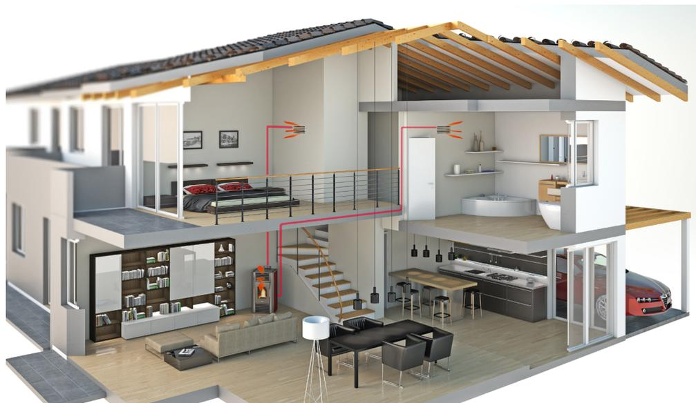
Fig. 45 - Beispiel einer Kanalisierung
