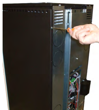
Fig. 62 - Lösen der hinteren Schraube
