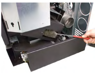
Fig. 80 - Reinigung mit Flaschenbürste 2
