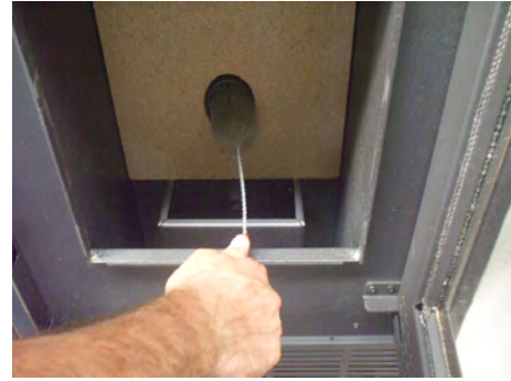
Fig. 59 - Reinigung mit Flaschenbürste
