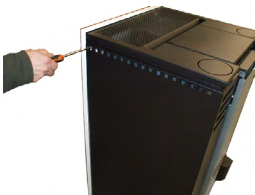
Fig. 61 - Lösen der oberen Schraube
