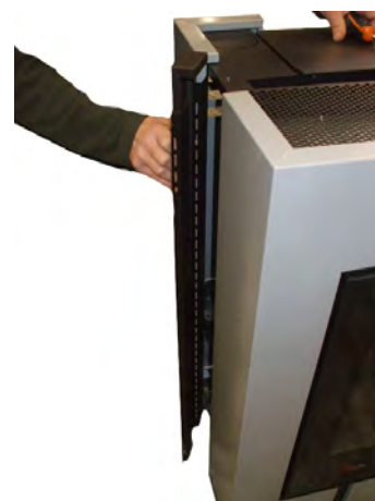
Fig. 65 - Herausnehmen der mittleren Platte
