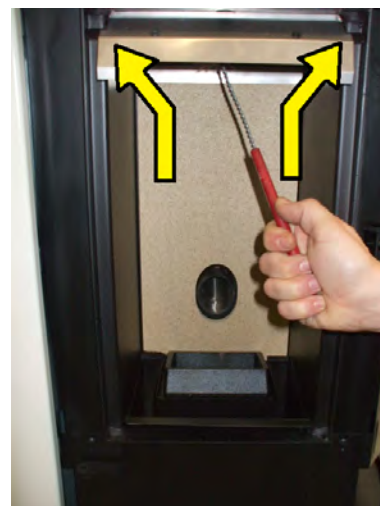
Fig. 78 - Beide Rohre reinigen
