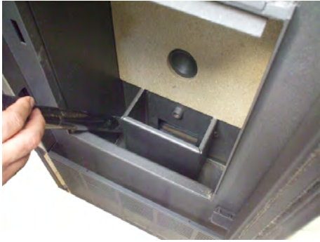
Fig. 58 - Reinigung Fach Brennschale
