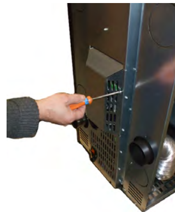
Fig. 89 - Entfernen hinteres Gehäuse
