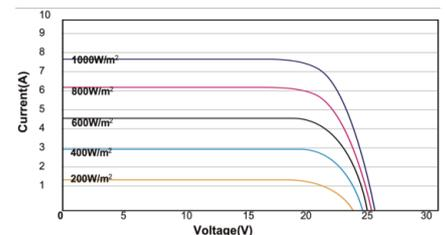
**PV-Kurven des PV-Moduls**
