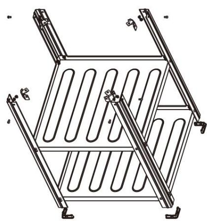
Schritte: 1. Nehmen Sie die Palette und die Füße und befestigen Sie sie mit 24 Schrauben und Muttern.
