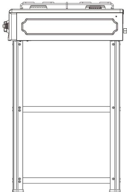
Schritt 3. Setzen Sie den Ofenkörper auf die Halterung und befestigen Sie ihn mit 4 Schrauben.
