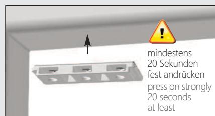
(1) Beiliegende Klebefolie von der Trägerfolie abziehen und auf der Klebeplatte anbringen. **Dabei die Klebefläche möglichst nicht berühren, um die Klebekraft nicht zu verringern.** Fest andrücken, mehrmals drüberreiben!
