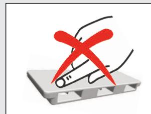
Plissee-Klebeplatten halten auf Kunststoff- und Aluminium-fensterrahmen, welche nicht speziell beschichtet, gemasert, uneben oder rau sind (Glasleistentiefe mind. 13 mm). Bei der Verarbeitung der Klebeplatten achten Sie bitte auf saubere und trockene Oberflächen, welche frei von z.B. Fett-, Öl- oder Silikonfilmen, sowie Schmutzpartikeln sein müssen (mit Lösungsmitteln gereinigte Flächen müssen mindestens 2 Stunden nach der Reinigung ablüften).
