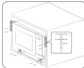
10. Bringen Sie mit einem 3-mm-Bohrer entsprechende Bohrungen am Schrank an, mit denen Sie die Sockelhalterung befestigen. Ziehen Sie dann die mitgelieferten Schrauben (Typ B) fest.
