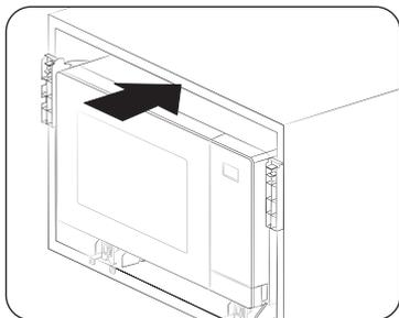
9. Schieben Sie das Gerät in den Schrank. Richten Sie dann die Bohrungen der Sockelhalterung an den Markierungen aus Schritt 4 und 7 aus.
