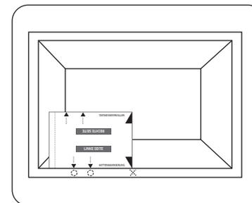
1. Messen Sie die Länge des Schrankes aus, in den Sie die Mikrowellen einbauen möchten, und setzen Sie in der Mitte des Schrankes eine Markierung.
