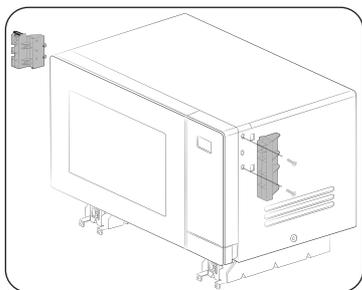
8. Befestigen Sie die beiden Blendenhalterungen mit den mitgelieferten Schrauben (Typ A) jeweils an der linken und rechten Seite des Mikrowellengeräts.
