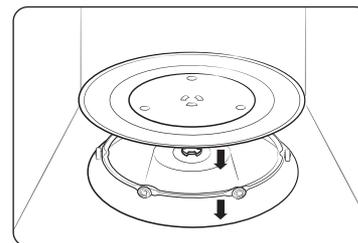
1. Entnehmen Sie das Verpackungsmaterial aus dem Inneren des Geräts. Setzen Sie den Drehring und den Drehteller ein. Vergewissern Sie sich, dass der Drehteller problemlos gedreht werden kann.
