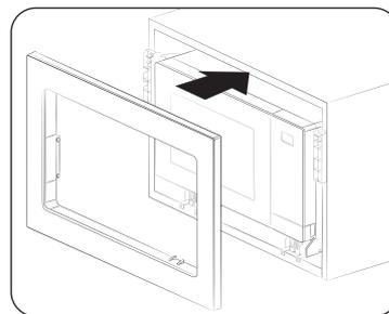
11. Befestigen Sie die Blende, und schließen Sie anschließend alle Stromkabel an. Überprüfen Sie die Funktionsfähigkeit des Geräts.
