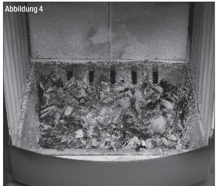
Lassen Sie diese Holzauflage mit geöffneten Verbrennungsluftreglern herunterbrennen, bis eine Grundglut vorhanden ist (Abb. 4). Je nach Holzgüte, Schornsteinzug und Witterung dauert diese Verbrennungsphase unterschiedlich lange. Legen Sie jetzt zwei weitere Holzscheite parallel zur Feuerraumscheibe auf und verschließen Sie die Feuerraumtür (Abb. 5).
