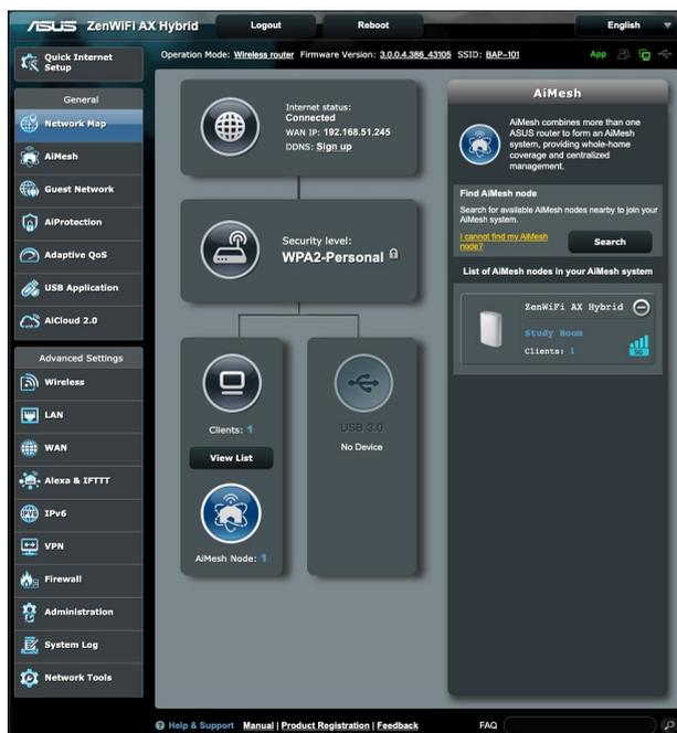
3. Wenn der AiMesh-Netzknoten auf dieser Seite angezeigt wird, klicken Sie darauf, um ihn zum AiMesh-System hinzuzufügen. Dies dauert eine gewisse Zeit. Bitte warten Sie, bis das Hinzufügen des AiMesh-Netzknotens abgeschlossen ist.
