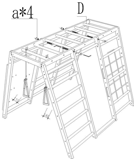
Connectez le haut de la partie D et avec le cadre d'escalade installé à l'étape 6 et à l'étape 7 à travers 4 pièces de vis M6 \* 35.
