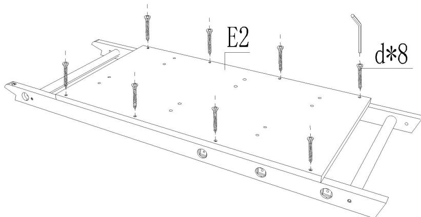
Verbinden Sie die Platine E2 mit dem im ersten Schritt montierten Teil und befestigen Sie es mit 8 Stück M5\*35 Schrauben.
