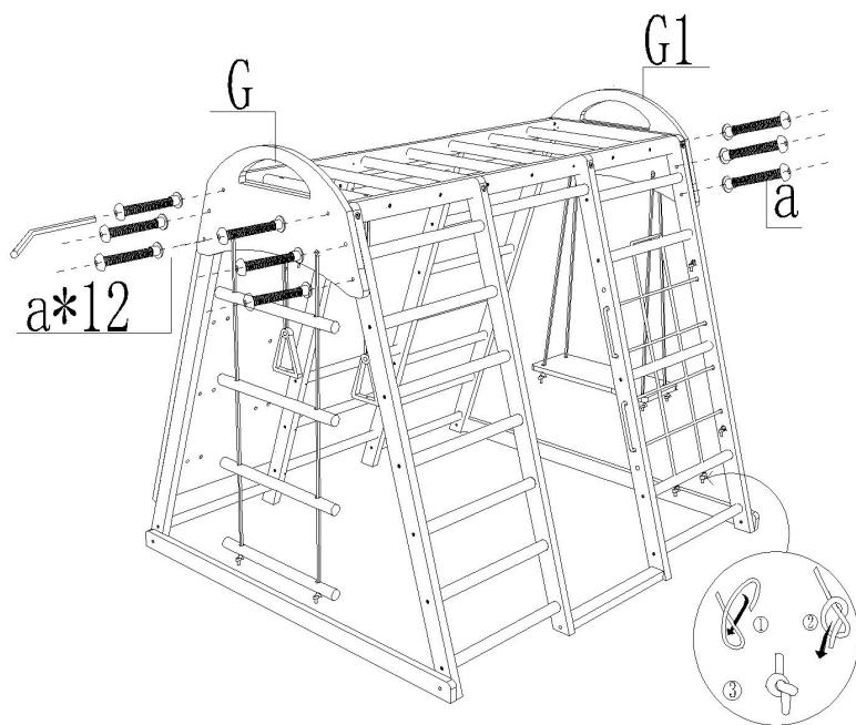
Installez le G et G1 avec une échelle d'escalade et balancez-vous sur le côté du cadre d'escalade avec 12 pièces de vis M6 \*35 .
