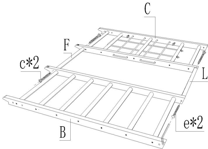
Connectez 2 bâtons ronds F entre la partie B et la partie C, et utilisez 2 pièces de M5\*30 & 2 pièces de M3.5\*60 pour serrer.
