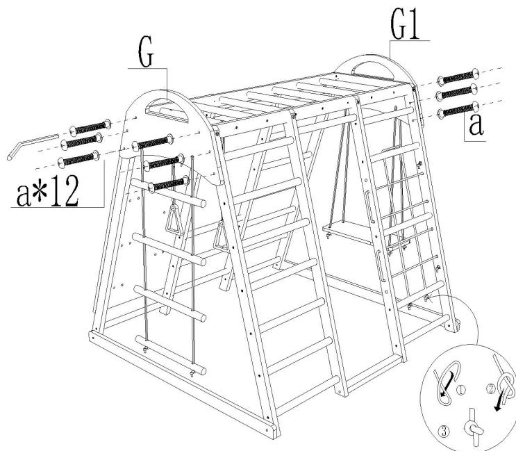
Installieren Sie G und G1 mit der Kletterleiter und schwingen Sie sie mit 12 Stück M6\*35-Schrauben zur Seite des Klettergerüsts.
