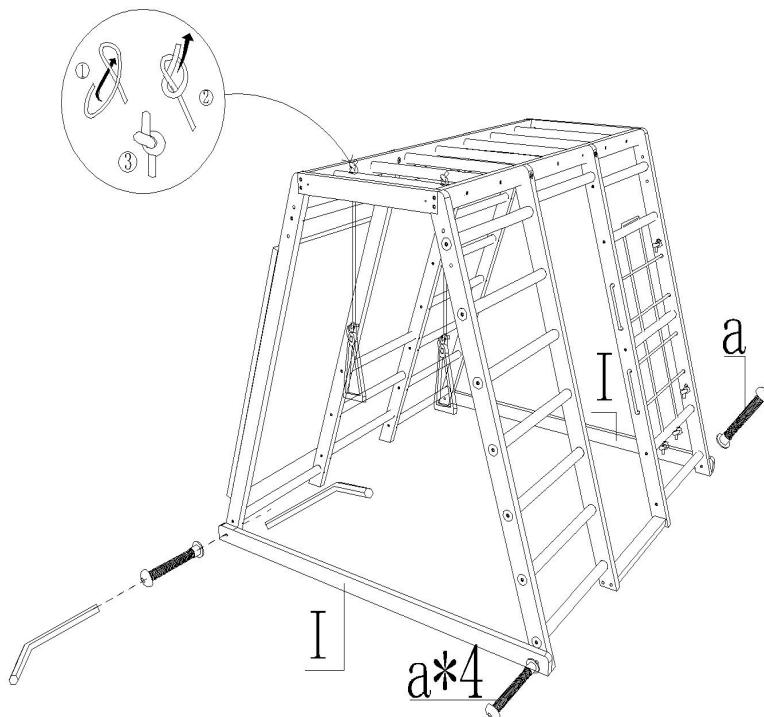
Utilisez 4 pièces de vis M6 \*35 pour fixer les deux poutres I au bas du cadre d'escalade.
