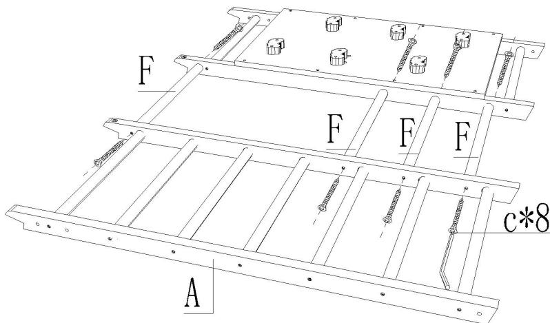
Connectez 4 bâtons ronds F entre la pièce installée à la troisième étape et la partie A, et connectez-vous avec 8 pièces de M5 \* 30. Gardez-le de côté pour une utilisation ultérieure.
