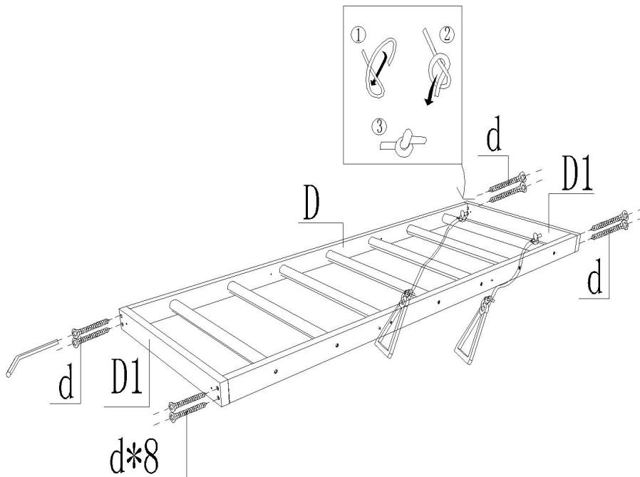
Verbinden Sie D1 mit der Kletterleiter D und befestigen Sie sie mit 8 Stück M5\*35. Für die weitere Installation beiseite legen.
