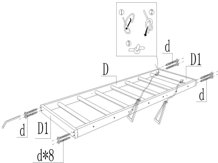
Connectez D1 à l'échelle d'escalade D et fixez-la avec 4 pièces de M5\*35. Mettre de côté pour une installation ultérieure.
