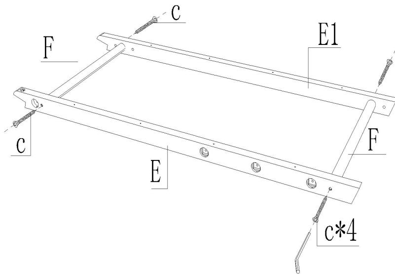
Préparez E et E1, connectez-les avec deux bâtons ronds F, et fixez-les avec 4 pièces M5\*30.
