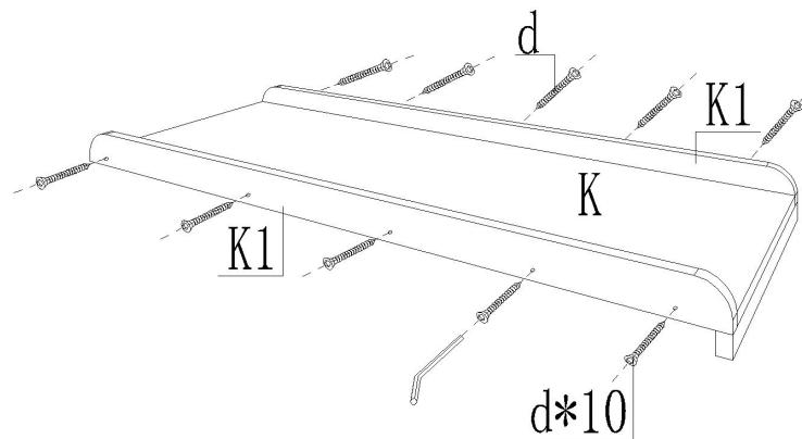
Connectez les deux panneaux latéraux de glissière K1 à la glissière K et fixez-les avec 10 pièces de vis M5\*35. Mettre de côté pour une installation ultérieure.
