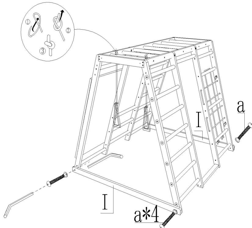
Verwenden Sie 4 Stück M6\*35-Schrauben, um die beiden Balken I an der Unterseite des Klettergerüsts zu befestigen.
