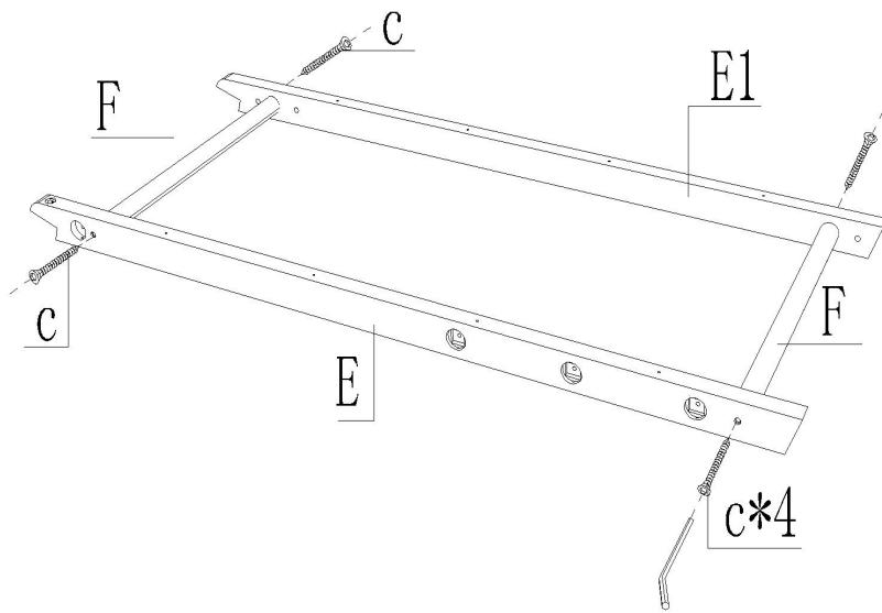
Bereiten Sie E und E1 vor, verbinden Sie sie mit zwei F-Rundstäben und befestigen Sie sie mit 4 Stück M5\*30.
