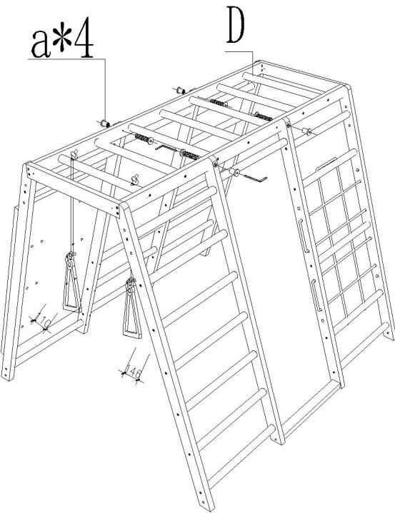
Verbinden Sie die Oberseite von Teil D und mit dem in Schritt 6 und Schritt 7 installierten Klettergerüst durch 4 Stück M6\*35-Schrauben.
