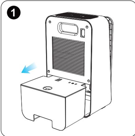
1. Wenn der Tank voll ist, blinkt das rote LED- Licht und der Luftentfeuchter stoppt. Funktioniert automatisch. Zurückziehen Sie den Netzstecker und entfernen Sie den Wassertank.
