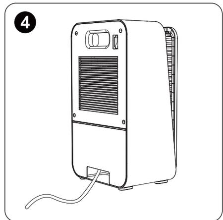
4. Wenn Sie den Luftentfeuchter in einem Badezimmer verwenden, können Sie einen Abflussschlauch anschließen, um für einen kontinuierlichen Wasserabfluss anzuschließen, so dass der Wassertank nicht häufig geleert werden muss.
