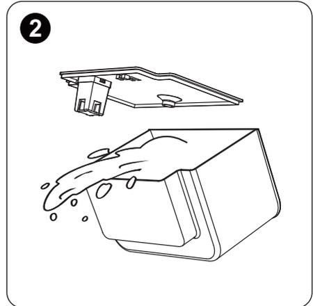
2. Entfernen Sie den Deckel des Wassertanks und entsorgen Sie das aufgefangene Wasser.
