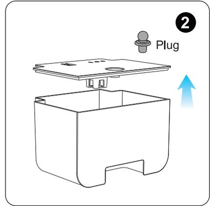
2. Stecker aus dem Einlass des Tanks entfernen und aufbewahren (Der Stecker muss später wieder verwendet werden).
