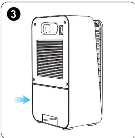
3. Setzen Sie die Abdeckung wieder in den Luftentfeuchter ein. Um die Entfeuchtung fortzusetzen, stecken Sie den Netzstecker ein und drücken Sie erneut die Taste „ON/OFF“.
