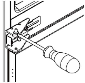
6. Schrauben Sie die obere Scharnierachse vom Scharnier ab. Drehen Sie darauf das Scharnier um und schrauben Sie die Scharnierachse ein.
