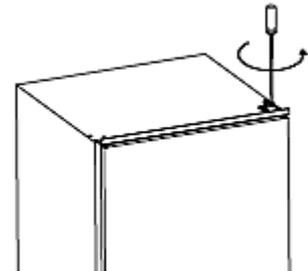
2. Schrauben Sie das mittlere Scharnier ab. Nehmen Sie dann die untere Tür ab und verwahren Sie diese an einem Ort, an dem sie nicht beschädigt werden kann.
