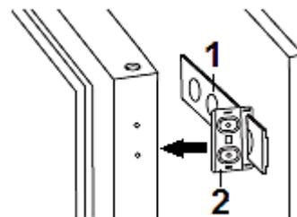
7. Überprüfen Sie gewissenhaft, ob die Tür sich reibungslos und ordnungsgemäß öffnet und schließt. Die Türdichtungen müssen ordnungsgemäß anliegen. Falls dem nicht so ist, können Sie das Gerät ein wenig justieren. Befestigen Sie dann die untere Klammer mit den beiden langen Schrauben am Schrank.
