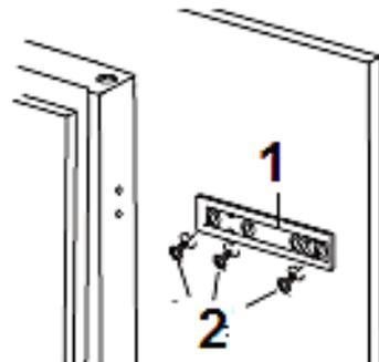
4. Schrauben Sie die Führung von der Gerätetür ab.
