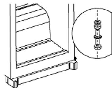
4. Versetzen Sie die mittlere Klammer von der linken auf die rechte Seite. Setzen Sie dann die untere Tür wieder ein.
