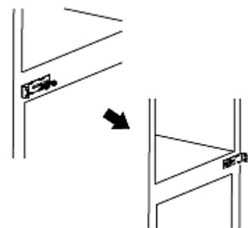
5. Versetzen Sie das mittlere Scharnier auf die linke Seite. Bevor Sie das mittlere Scharnier endgültig festziehen können, muss die untere Tür horizontal und vertikal ordnungsgemäß ausgerichtet sein, so dass die Türdichtungen an allen Seiten richtig anliegen.
