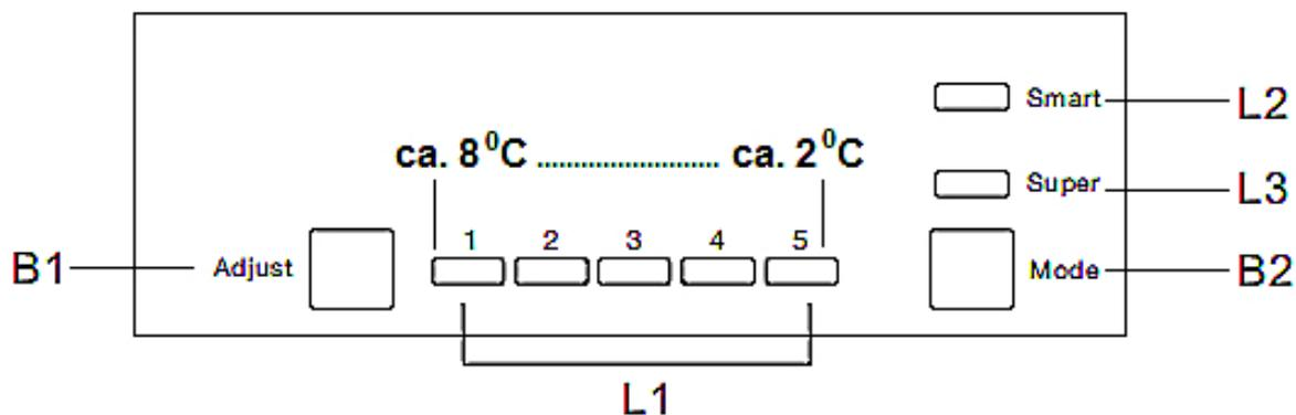
Die Leistungsstufen (1-5) regulieren die diversen Kühlstufen im Kühlabteil.
