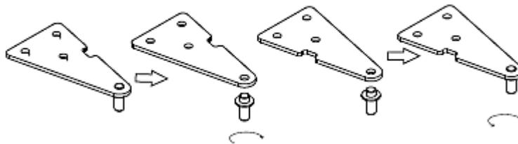
7. Setzen Sie die obere Tür wieder ein. Versetzen Sie das obere Scharnier auf die linke Seite. Bevor Sie das obere Scharnier endgültig festziehen können, muss die obere Tür horizontal und vertikal ordnungsgemäß ausgerichtet sein, so dass die Türdichtungen an allen Seiten richtig anliegen.
