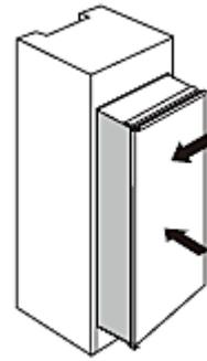
2. Schrauben Sie eine Führung in den Löchern der Gerätetür mit den kurzen Schrauben fest. Schieben Sie das Gleitelement in die Führung; öffnen und schließen Sie dann die Gerätetür und die Schranktür komplett, um zu überprüfen, ob sich die Schranktür komplett und reibungslos schließen lässt.
