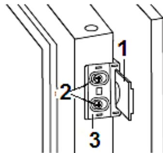
3. Öffnen Sie zusammen die Geräte- und Schranktür und markieren Sie die Position des Gleitelements, wenn das Gleitelement bei allen Winkelpositionen während des Öffnens und Schließens gut arbeitet. Nehmen Sie das Gleitelement aus der Führung und befestigen Sie es mit zwei kurzen Schrauben an der Schranktür. Befestigen Sie dann die Gleitelementabdeckung auf dem Gleitelement.
