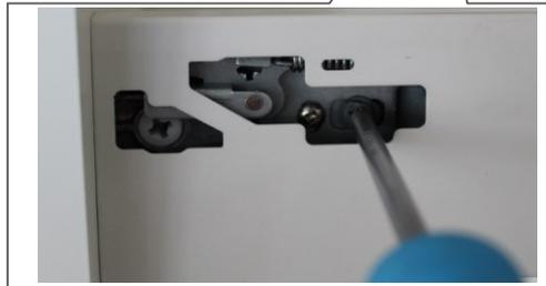
Mit Betätigung der vorderen Schraube wird die Fronteinstellung in horizontaler Richtung vorgenommen!
