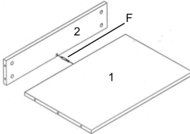
Montieren Sie das Teil (2) an die Unterseite (1) mithilfe von (F).
