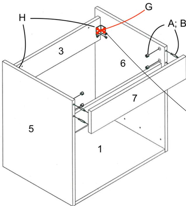
Verbinden Sie nun Teil (7) an die Seitenteile (5) und (6). Des Weiteren montieren Sie die beiden Winkelteile in den Winkel von (3) und (6) sowie (3) und (5). Schrauben Sie diese mit den Schrauben (G) fest [6 Schrauben pro Winkelstück]
