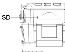
Hinweis: Die Kamera besitzt keinen integrierten Speicher. Deswegen muss vor der Verwendung eine Speicherkarte in die Kamera eingelegt werden. Wenn die Speicherkarte in einer anderen Kamera benutzt wurde, formatieren Sie die Speicherkarte vor dem Gebrauch in der Wildtierkamera.
