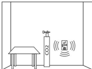
CO<sub>2</sub> aus Flaschen, bzw. sublimiert aus Trockeneis sinkt nach unten und sammelt sich bei unzureichender Durchlüftung in Bodennähe.
