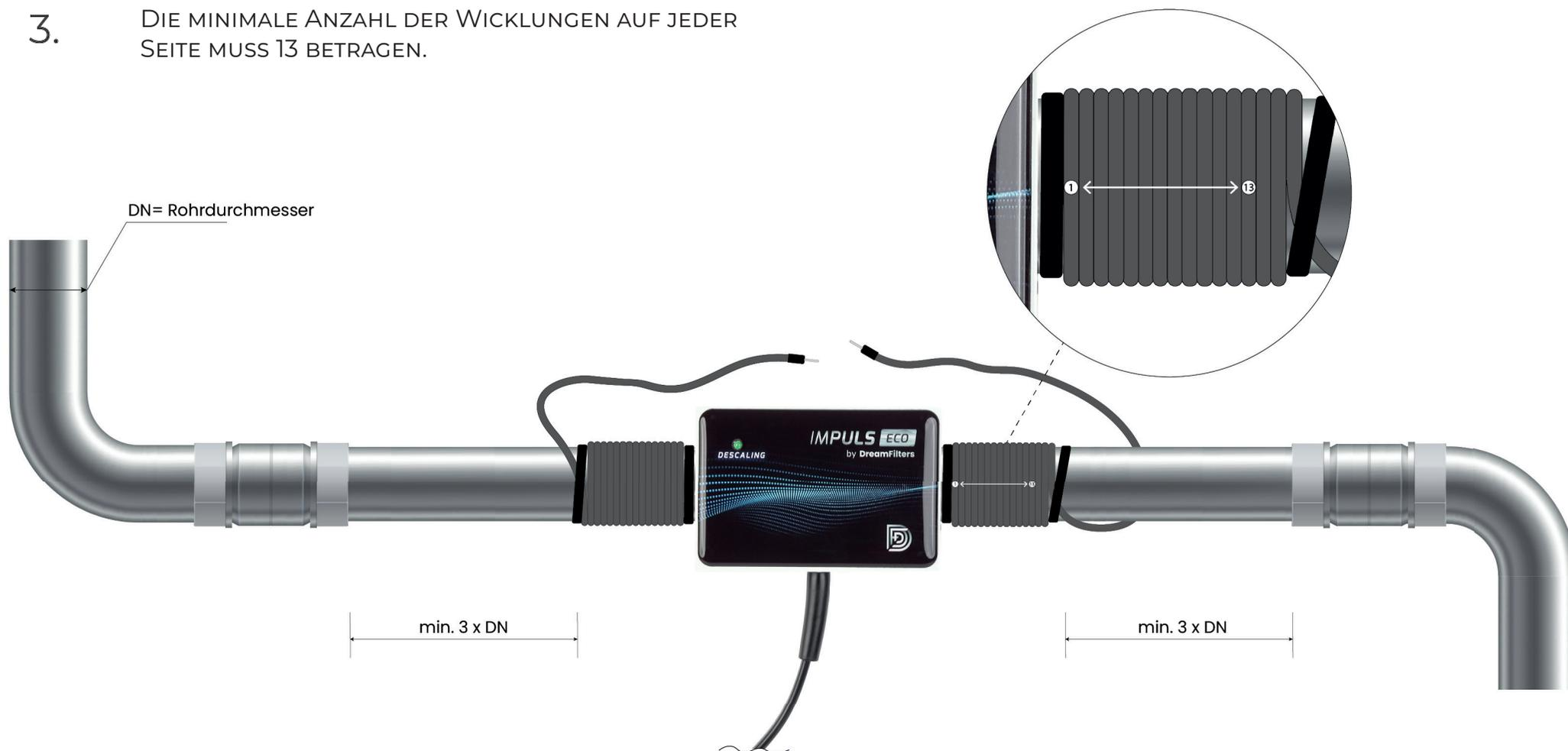
**\*TIPP:** WENN ES MÖGLICH IST, MEHR ALS 13 WICKLUNGEN AUF DEM ROHR ANZUBRINGEN, IST ES RATSAM, DIES ZU TUN. DADURCH WIRD EINE STÄRKERE WIRKUNG DES ELEKTROMAGNETISCHEN FELDES ERZEUGT.
