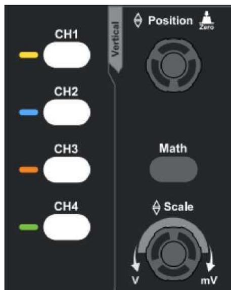
Abb. 3-10 Bedienelemente für Vertikalsteuerung
