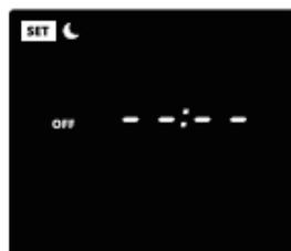
OFF: Der Nachtmodus ist ausgeschaltet. Auch wenn längere Zeit keine Bedienung erfolgt, bleiben das Display und die LED-Kontrollleuchte immer eingeschaltet.
