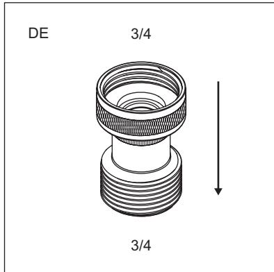
4. Das Rückschlagventil muss am Wasserhahn montiert werden.
