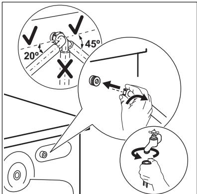
2. Drehen Sie ihn nach links oder rechts, je nach Position des Wasserhahns. Vergewissern Sie sich, dass sich der Zulaufschlauch nicht in einer vertikalen Position befindet.
