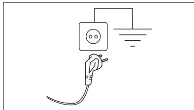
Nach der Installation des Geräts muss das Stromkabel leicht zugänglich sein.
