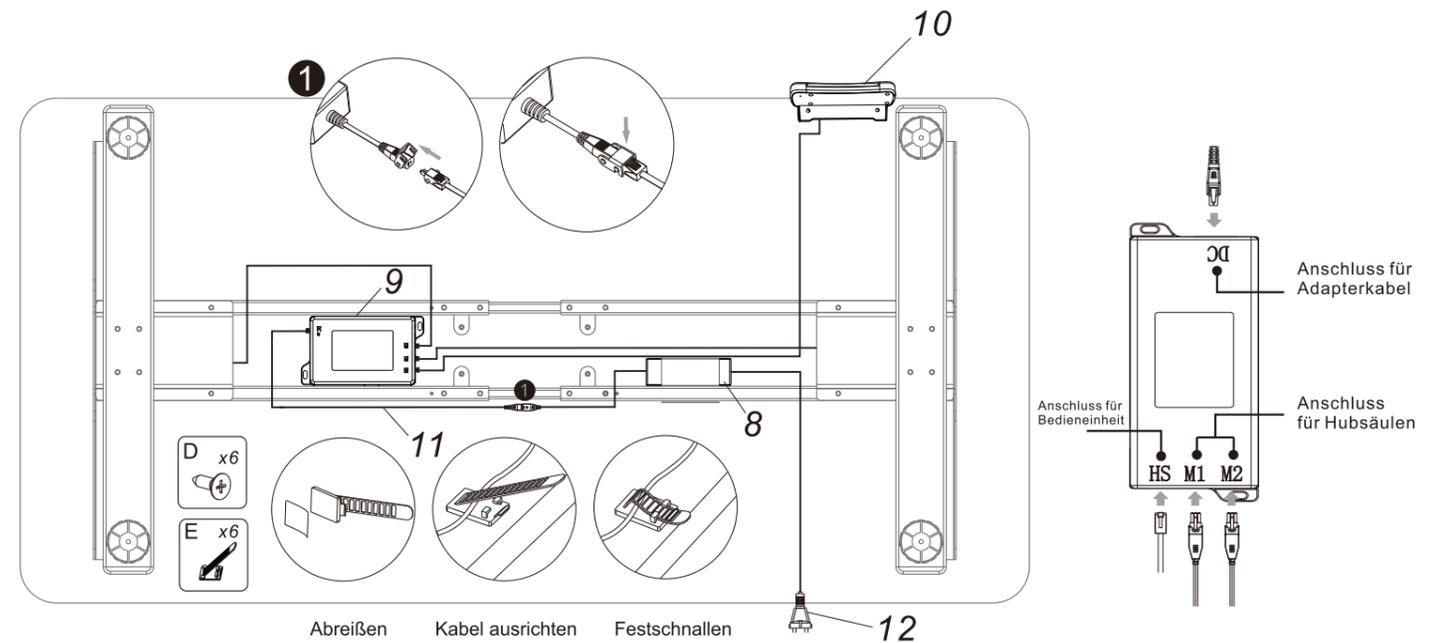
Alle Kabel können mit Kabelbinder (E) an dem Tisch befestigt werden. Mit Schrauben (D) können Kabelbinder (E) auch an der Tischplatte befestigt werden, um Kabel zu integrieren.
