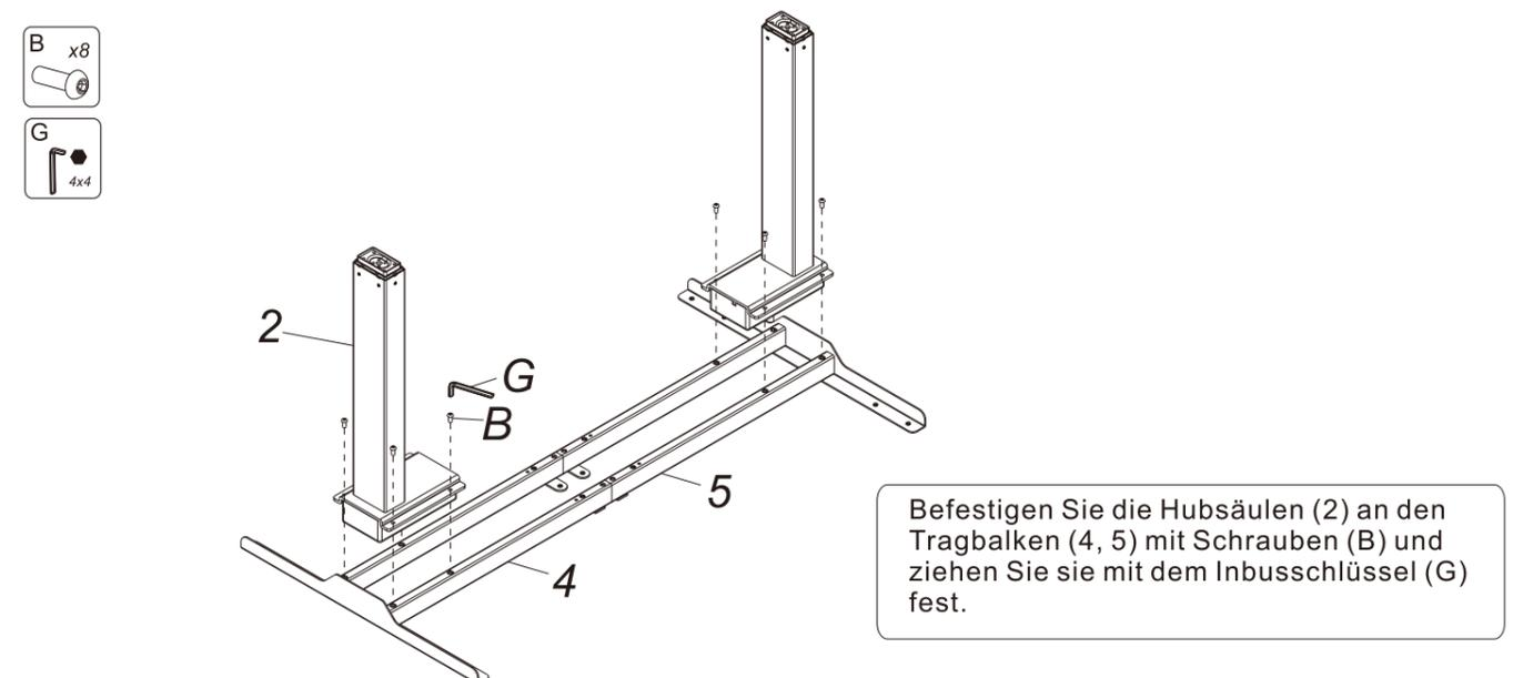
Befestigen Sie die Hubsäulen (2) an den Tragbalken (4, 5) mit Schrauben (B) und ziehen Sie sie mit dem Inbusschlüssel (G) fest.
