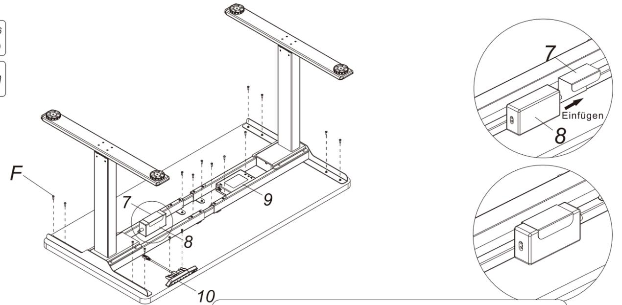
Befestigen Sie zuerst die Tischplatte mit Schrauben (F). Installieren Sie dann die Control Box und die Bedieneinheit mit Schrauben (F) an die Tischplatte. Fügen Sie schließlich den Adapter (8) in die Adapterhalterung (7) ein.
