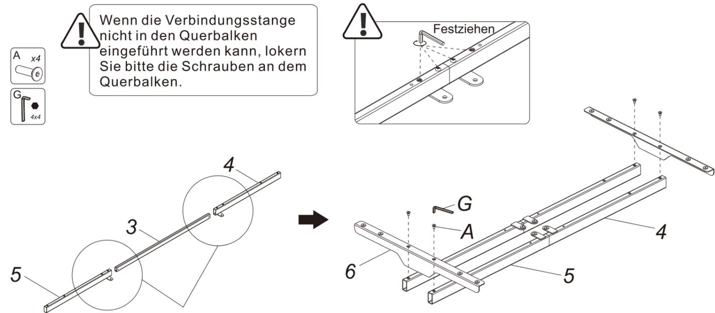
Verbinden Sie linken und rechten Tragbalken (4, 5) mit der Verbindungsstange (3) und ziehen Sie sie mit dem Inbusschlüssel (G) fest.
