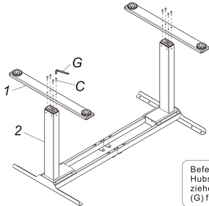
Befestigen Sie die Tischfüße (1) an den Hubsäulen (2) mit Schrauben (C) und ziehen Sie sie mit dem Inbusschlüssel (G) fest.
