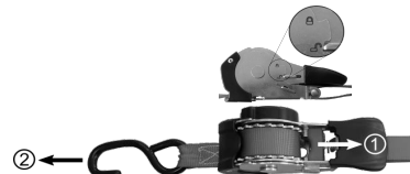
Bild 2: Ausrollen des Spanngurtes
