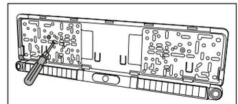
4. Kennzeichen einsetzen und in die unteren Haltenasen (2) einrasten.
