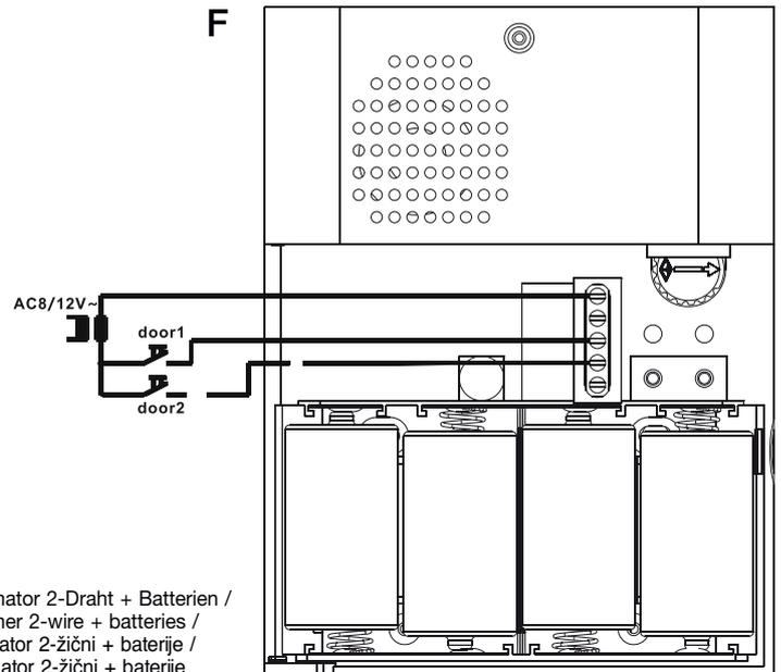
Transformator 2-Draht + Batterien /
