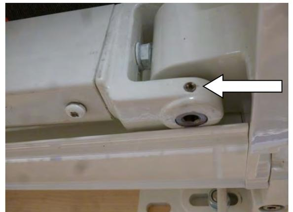
Jetzt lässt sich der Exzenterbolzen mühelos mit einem 6er Inbusschlüssel drehen. Je nach Drehrichtung senkt oder hebt sich der Gelenkarm, somit gleichen Sie die Parallelität der Gelenkarme wieder an. Bei Bedarf, auf der gegenüberliegenden Seite, ebenfalls vornehmen. Nach erfolgter Einstellung muss die Sicherungs-Inbusschraube mit dem 2,5mm Inbusschlüssel wieder angezogen werden – um ein selbständiges Verstellen des Exzenterbolzens zu verhindern.
