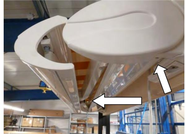
Der Gelenkarm kann nun mit einem 17er Ring-/Gabelschlüssel justiert werden. Durch Anziehen der oberen Schraube bewegt sich der Arm nach oben, durch Anziehen der unteren Schraube bewegt sich der Arm nach unten.
