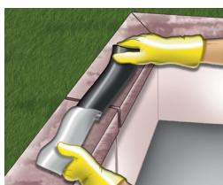
4. Verwijder de beschermfolie van de tape (aan één of beide kanten, afhankelijk van het type) en breng de tape aan op het te repareren element.
