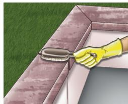
1. Nettoyer la surface: pour obtenir une adhérence optimale, les surfaces doivent être à la fois sèches et propres.
