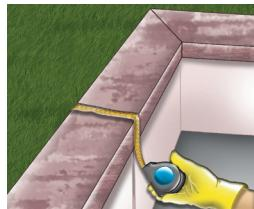
2. Band abmessen: Messen Sie die gewünschte Länge des Bandes ab. Planen Sie nötige Überlappungen mit ein.
