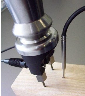
Hohlhammerlektrode GHE91 mit Temperaturfühler GTF38
