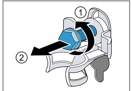
3. Die Netzanschlussleitung von der Halterung entfernen.
