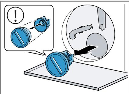
Der Pumpendeckel besteht aus zwei Bauteilen die zur Reinigung auseinandergelöst werden können.
